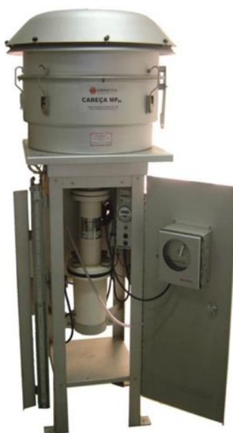
Figura 3.8-2 - Equipamento para amostragem de PI.
