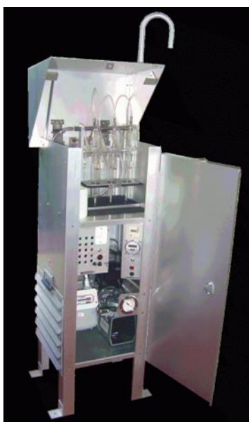
Figura 3.8-3 - Equipamento para medição de SO 2 e NO 2 .
