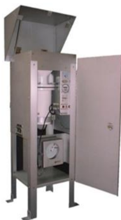
Figura 3.8-1 - Equipamento para amostragem de PTS (HI-VOL).
