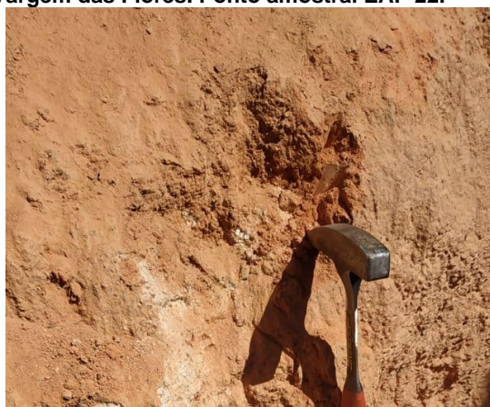
Figura 2.2-5 – Alterações e mantos de intemperismo (A) Material argilo-siltoso com cores brancas e alaranjada. Ponto amostral EAF-23.
