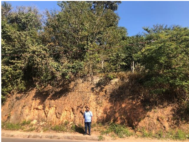
Figura 10.7-7 – Perfil de Latossolo Vermelho. Ponto Amostral EMF – 053.
