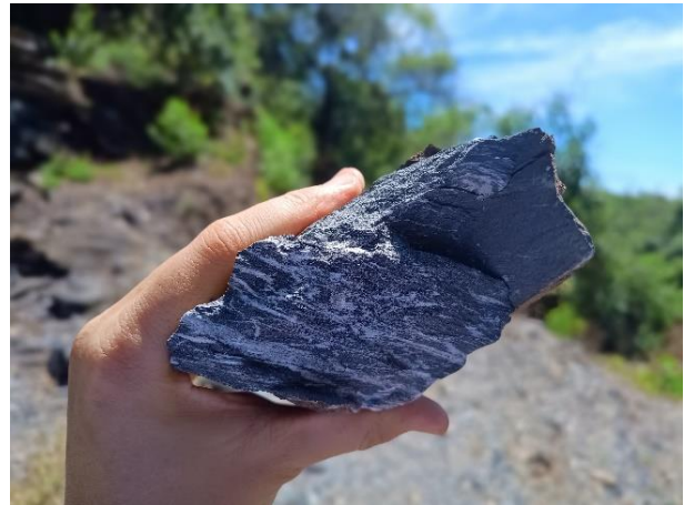
Figura 10.5-18 – Amostra de calclutito com vênulas de calcita. Ponto Amostral EMF - 160.
