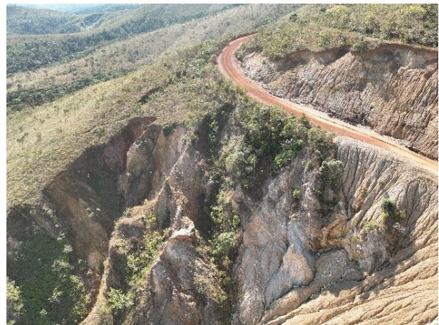
Figura 10.5-14 – Voçoroca associada a rochas e sedimentos arenosos da Formação Cercadinho. Ponto Amostral EMF – 068.
