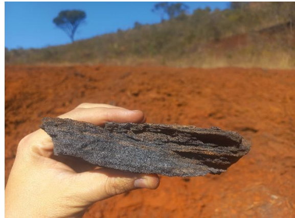
Figura 10.5-12 – Amostra de mão de itabirito especularítico da Formação Cauê. Ponto Amostral EMF - 067.
