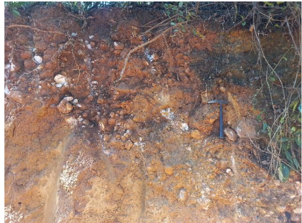
Figura 10.5-24 – Depósito coluvionar em solo argiloso, Formações Sete Lagoas, Grupo Bambuí. Ponto Amostral – EMF -010.
