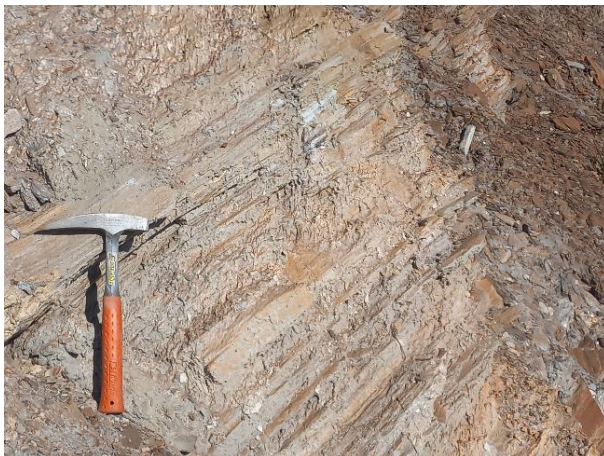
Figura 10.5-13 – Afloramento de intercalações de quartzitos e filitos da Formação Cercadinho. Ponto Amostral EMF -065.
