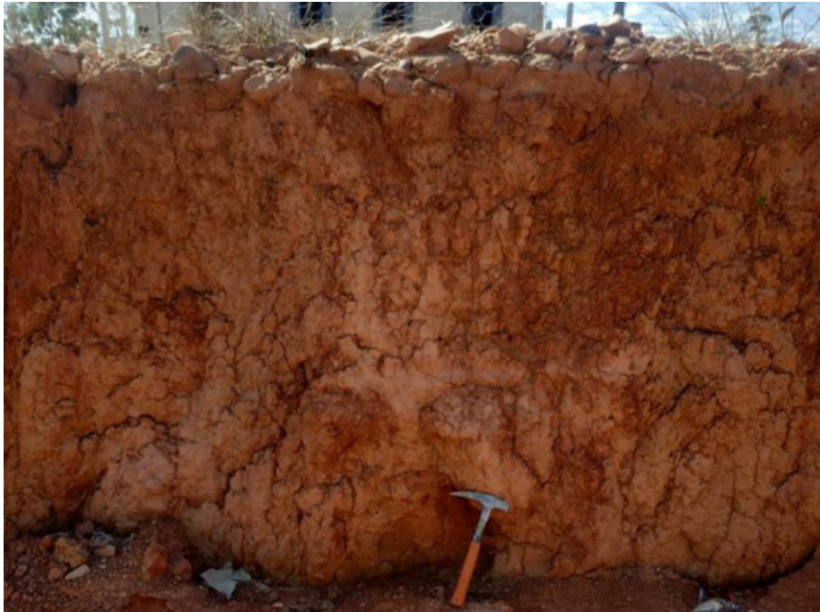
Figura 10.7-9 – Perfil de Cambissolo Háplico de cor avermelhada e textura silto-argilosa. Ponto Amostral EMF – 075.
