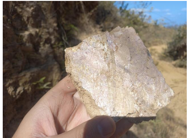
Figura 10.5-22 – Amostra de mão de siltito friável arroxeadado. Ponto Amostral EMF – 089.
