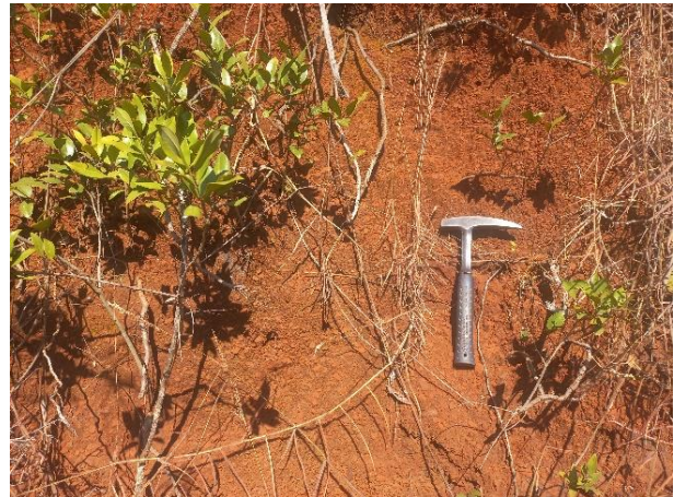
Figura 10.7-3 – Perfil de Neossolo Lítico com cores avermelhadas e fragmentos de formação ferrífera. Ponto Amostral EMF – 067
